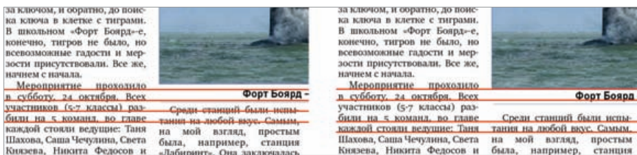
Рисунок 6. Неправильное (слева) и правильное (справа) привязывание к базовым линиям
